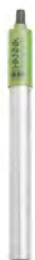
Électrode pH, corps en alliage titane, avec capteur de température intégré, connecteur DIN et câble 1 m HI 12963
