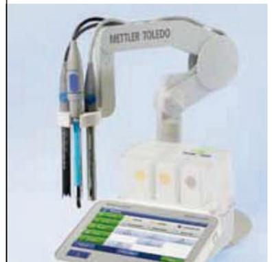
uPlace™ : actionnable d'une main, le bras d'électrode se déplace parfaitement à la verticale vers le haut/bas pour amener l'électrode à la position idéale. Les mesures gagnent en rapidité et les risques de renverser le contenu de l'échantillon ou d'endommager la sonde sont réduits !
